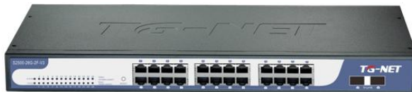
图 1.1.1 S2500-26G-2F-V3 以太网交换机前面板示意图
